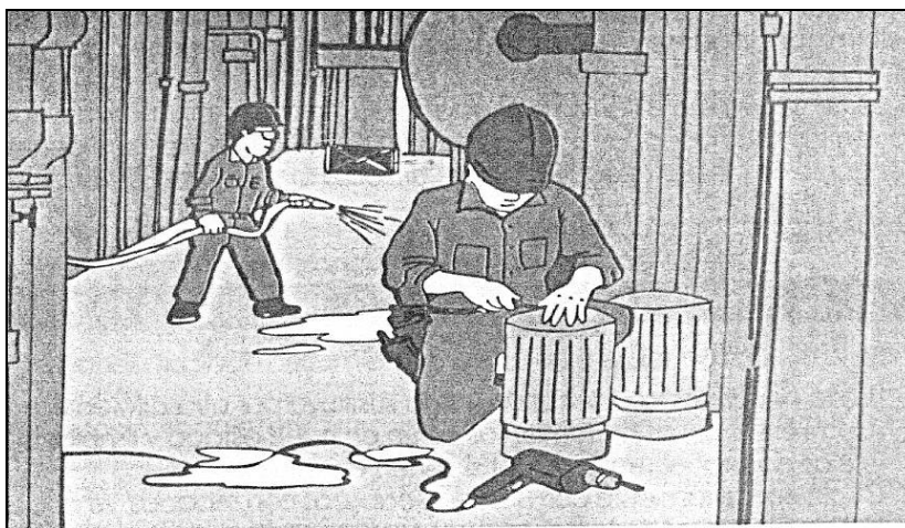
FIG. 21: Posible riesgo de accidente por área mojada y uso de equipo eléctrico.
